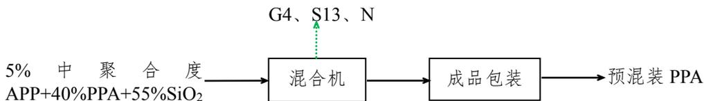
图 2.4-2 PPA 混装生产线及产污环节
