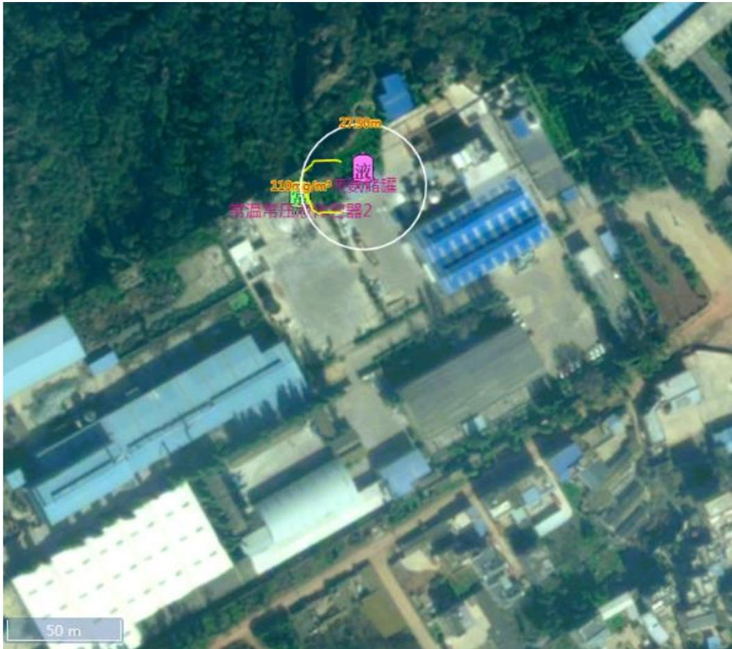
图 3.2-5 最常见气象条件下氨气泄漏轴线最大浓度图
